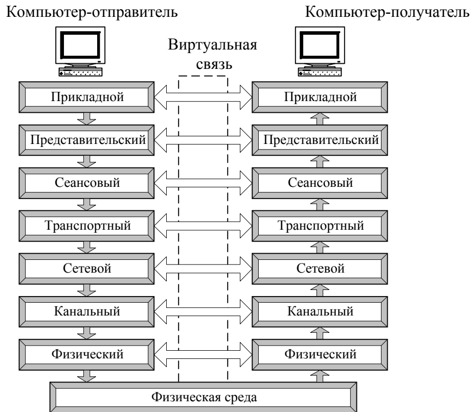
Рис. 2.2. Схема взаимодействия компьютеров в базовой эталонной модели OSI
